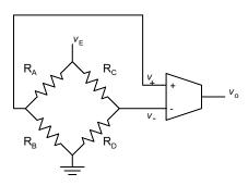
Raison d'être: convert tiny changes in resistance to voltage.
